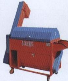
SB-2400봉지버섯탈봉기 Pot Cultivated Mushroom Separator · 봉지와 내용물이 자동선별분리 · 내용물이 승강기로 배출되어 차량에 적재용이
