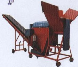
SB-4000자동상토기 Conveyor attached Type · 로더로 많이 투입 · 컨베어로 차량에 자동적재 · 컨베어 분리하여 사용
